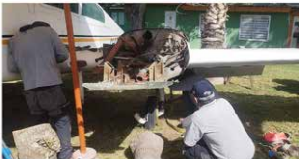
Trabajos en el ala del avión Cessna 310 y posterior colocación del motor izquierdo.
