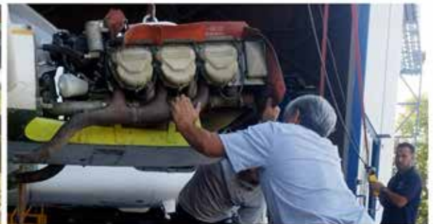
Trabajos en el ala del avión Cessna 310 y posterior colocación del motor izquierdo.
