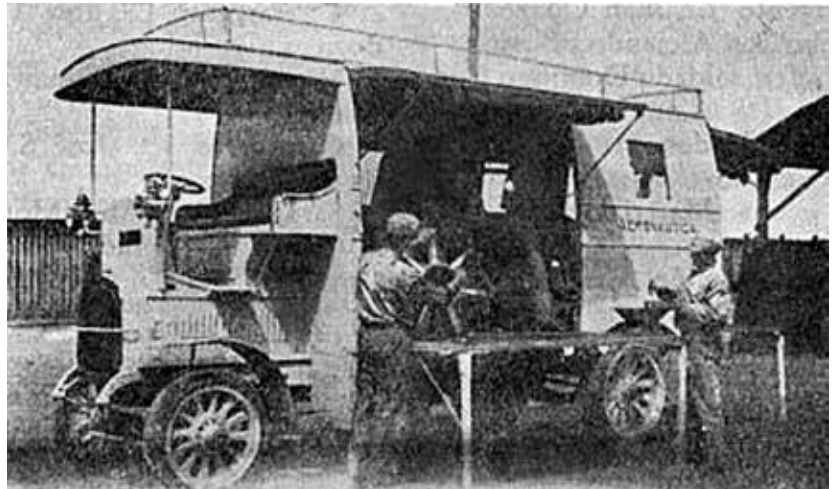
Auto-taller Delaye para el transporte de repuestos, herramientas y reparaciones de línea.
