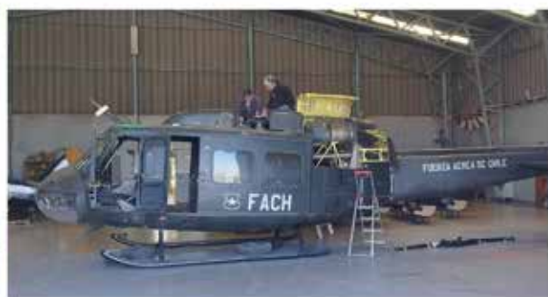
Instalacion del mastil en helicóptero UH-1H.
