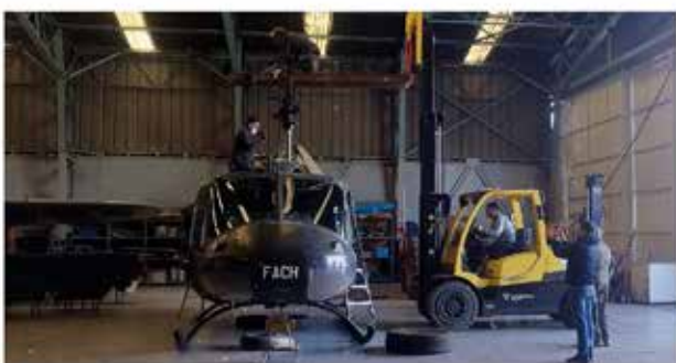
Helicóptero UH-1H, instalación del rotor principal.
